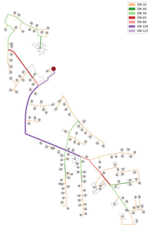
Abbildung 62: Vorauslegung eines möglichen Wärmenetzes für Maßnahme M6
